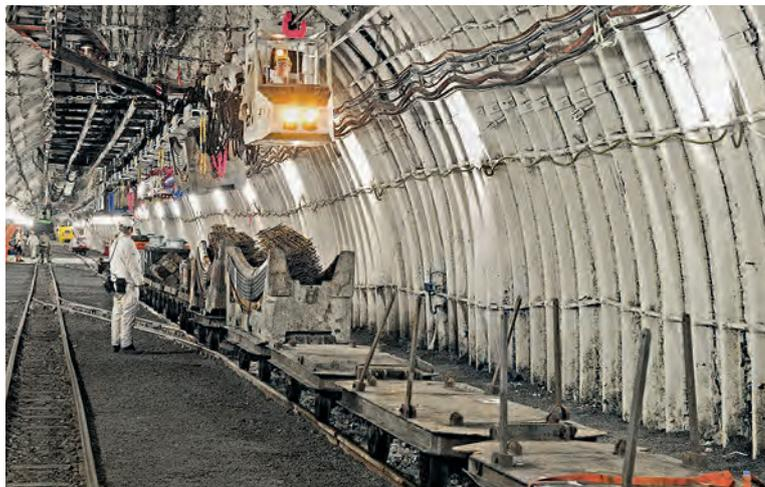
Eine „Dieselkatze“ schwebt entlang ihrer Führungsschiene an der Firste. Vom Prinzip her funktioniert diese Einschienenhängebahn wie die Wuppertaler Schwebebahn.
